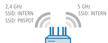
Abb.1 Dual Radio Access Point im Betrieb
